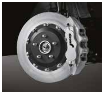
알콘(alcon) 모노블록 브레이크 시스템
