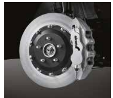
알콘(alcon) 모노블록 브레이크 시스템
